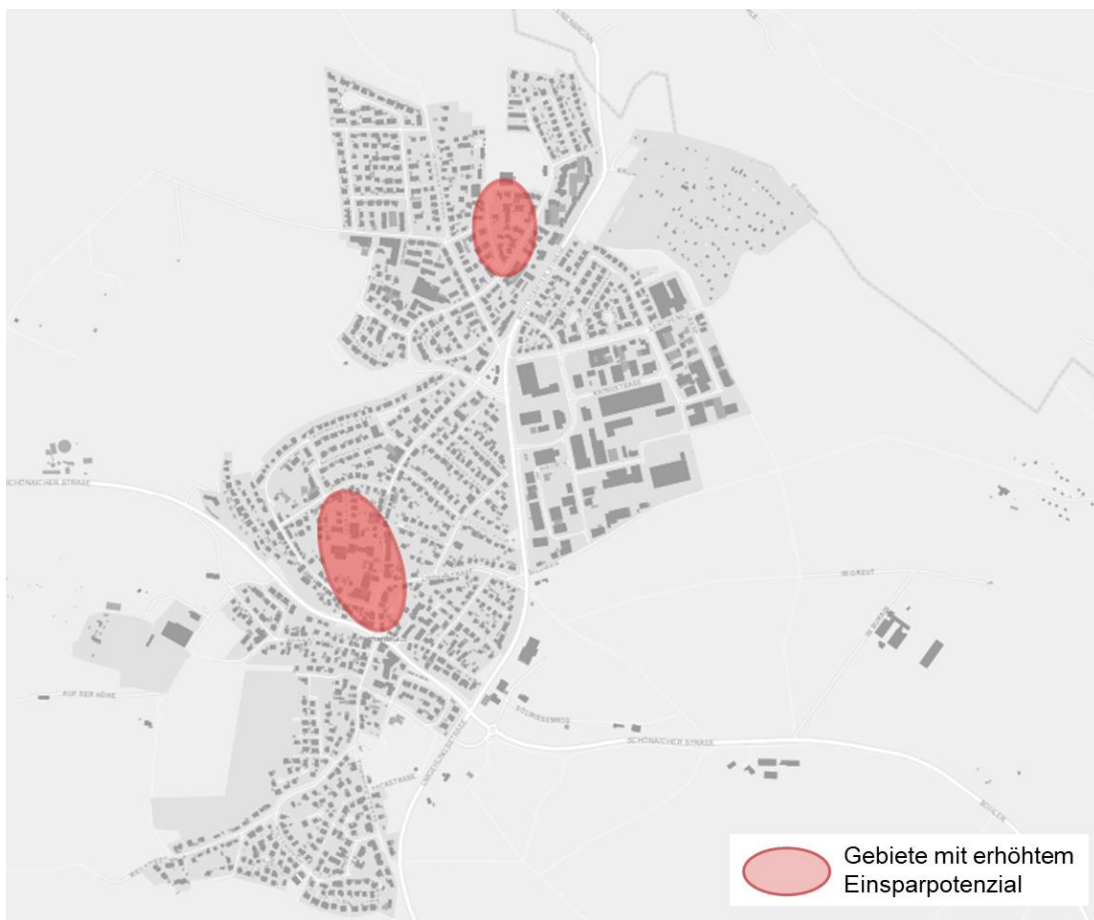
Abb. 46: Dezentral versorgte Teilgebiete mit erhöhtem Energieeinsparpotenzial
